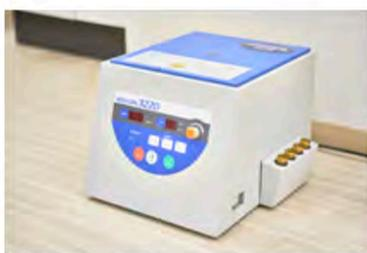
血液、尿、腹水などの体液検査をする際に、細胞成分と液体成分を分離するために用います。
